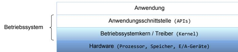
**Hardware** Die unterste Schicht im Modell bildet die Hardware. Es ist in der Regel nicht erwünscht, dass Anwendungen direkt mit dieser Ebene kommunizieren können.
